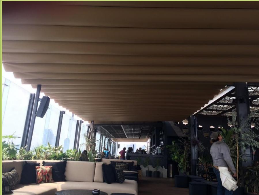
Este toldo esta diseñado para cubrir grandes áreas sin necesidad de que estén permanentemente techadas, ya que se pliega en uno de sus extremos para así dejar totalmente abierta el área, deslizando todos sus palillos bajo rieles; estos toldos pueden ser manuales o motorizados.
